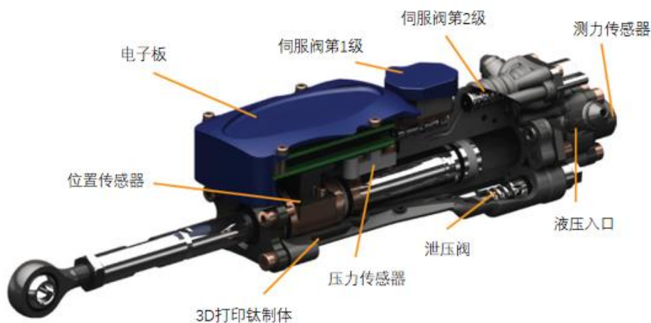
电液驱动关节结构示意图
