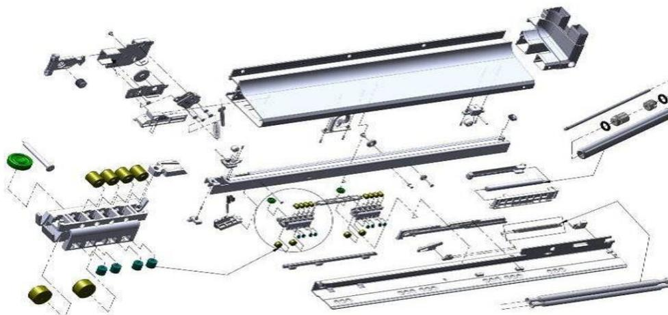
铰链：由可移动的组件或者可折叠的零件构成，是用来连接两个固体，并允许两者之间做转动的机械连接件。公司主要铰链产品结构图如下：
