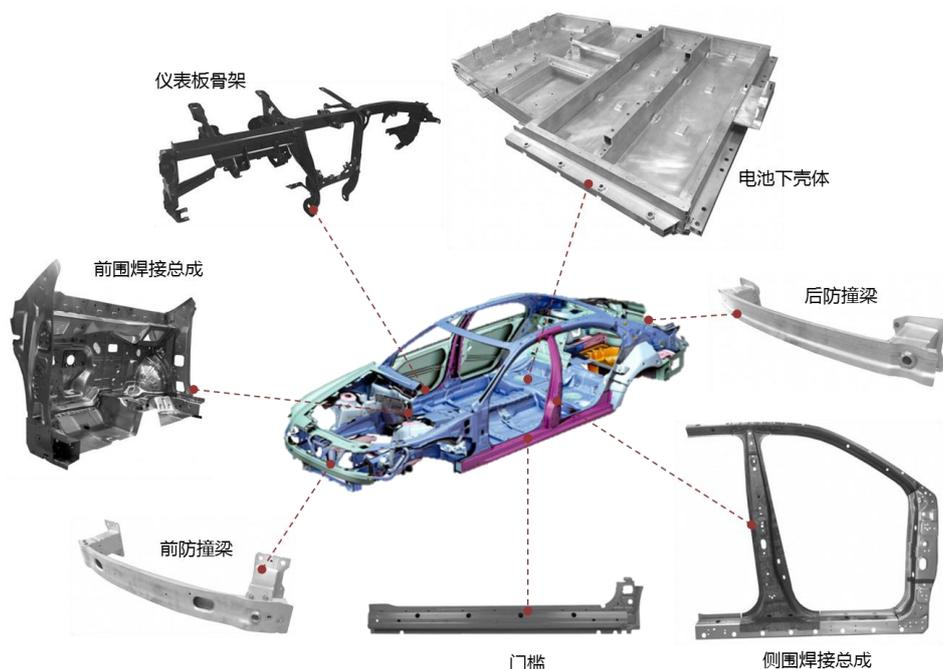
公司金属零部件主要包括仪表板骨架、防撞梁、门槛、EV 电池下壳体、车身冲压件等。
