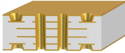
化学沉铜后 (孔壁绝缘基材覆盖铜)
