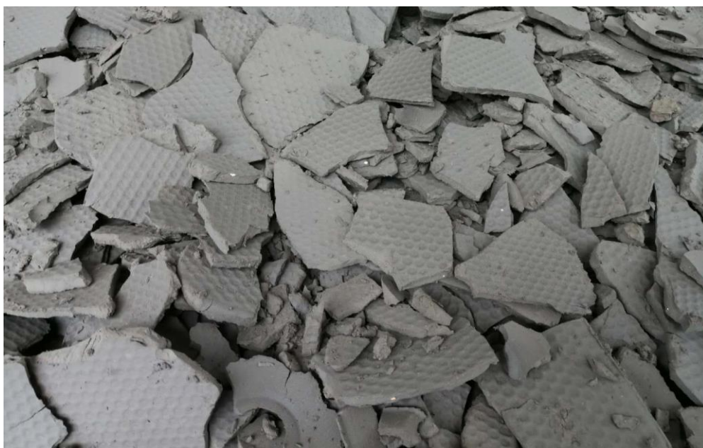
污泥淋滤深度脱水技术实物效果
