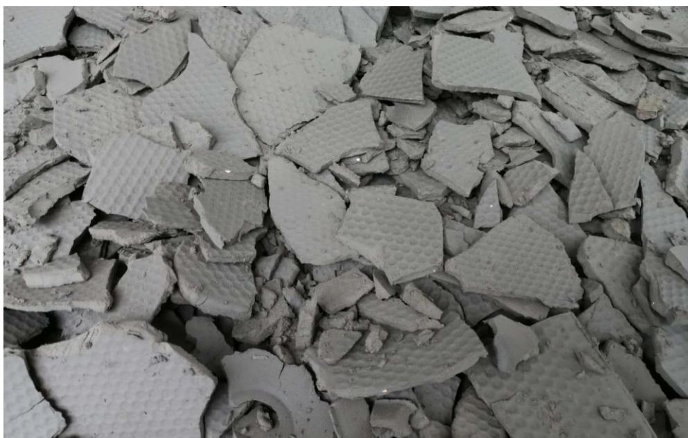
污泥淋滤深度脱水技术实物效果
