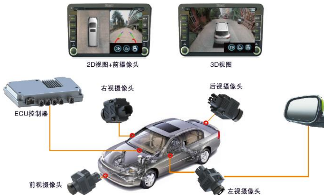
发行人车载摄像系统在全景摄像系统应用示意图
