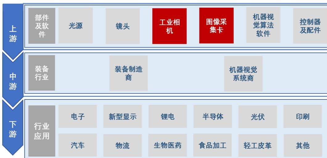
\*发行人主营产品处于机器视觉行业上游的核心部件，即工业相机及图像采集卡。
