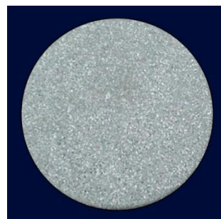
细化后晶粒形态(240μm)
