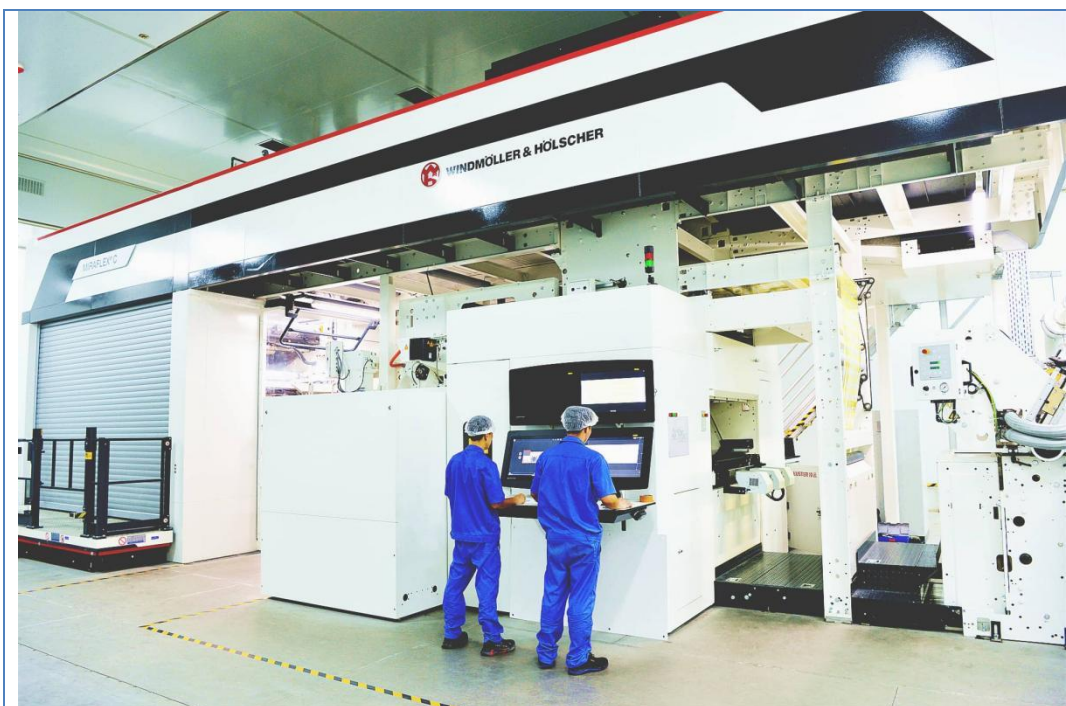
柔版印刷生产线
