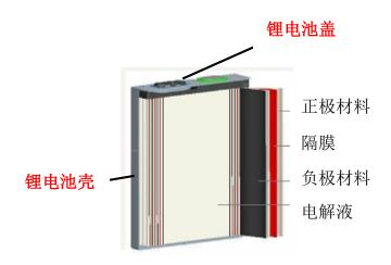
按下游应用,公司锂电池精密结构件主要以动力锂电池精密结构件为主,具体分为锂电池盖板和锂电池外壳,根据不同客户的要求,具体型号和规格有所差异,下图是公司动力锂电池精密结构件产品图片:
