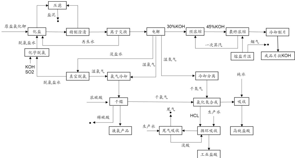
(2) 电子级盐酸及配套试剂级盐酸工艺流程图
