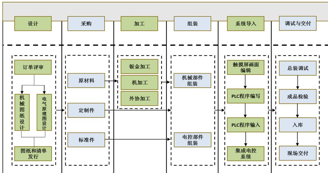
发行人核心技术主要体现在设计环节，加工、组装等环节则通过选用优质的原材料、采用特殊的机加工工艺进行加工并结合客户生产车间实际情况进行安装调试，从而实现核心技术效果，不直接体现核心技术。以发行人核心产品锂电干燥设备和涂布设备为例：
