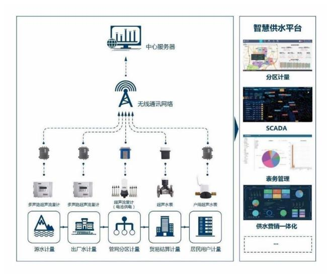
智慧社区供水解决方案成功应用于南方某市区水务集团独居老人关怀项目,系统采用"云+端"的先进架构(智慧水务云平台+智能超声水表),通过"AI用水数据分析算法",可分析得到用户画像、用水规律等信息,并依据分析结果对老人用水异常情况进行监测并通过多渠道告警提醒。项目得到社会各界广泛的关注和认可,并获得多家权威媒体报道。
