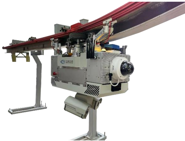
图 37、极寒轨道式智能巡检机器人
