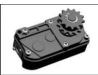
主要应用于房车滑移系统,体积小,扭矩大,于电机分离,拆卸方便,将电动机的旋转运动转变为链轮链条的直线往复运动,由滑动系统减速电机与链轮链条机构组成。由于空间狭小、密闭、用电等应用场景的限制,滑动系统减速电机需达到高效、响应快、发热小、可靠性高等技术要求。
