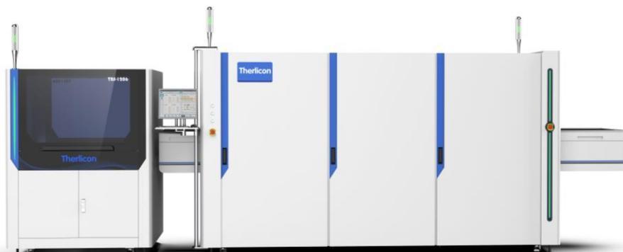
**无尘氮气烤箱、无尘压力烤箱**
