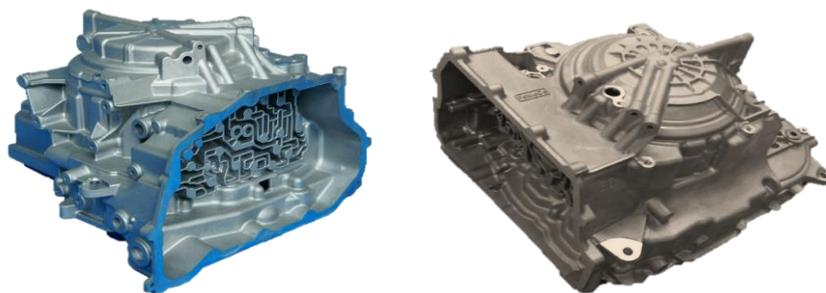
(3) 混合动力变速器箱体、增程式发动机缸盖、纯电动车电机壳体等。如下图：
