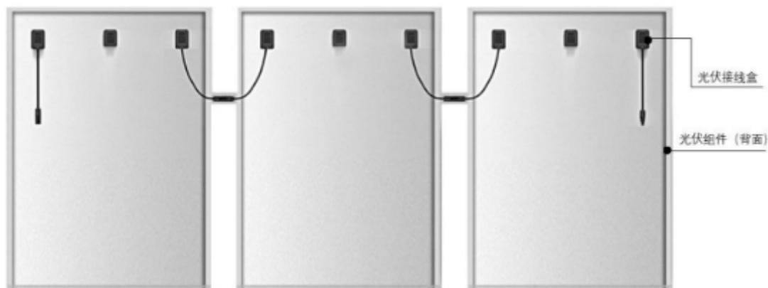
光伏接线盒产品主要由箱体、盒盖、自动保护器件、导体、底座、连接器、电缆线等配件构成。光伏接线盒结
