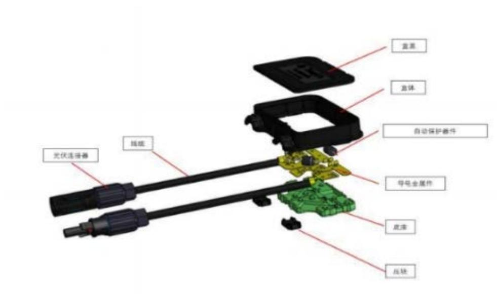
其中：①箱体、盒盖、底座等选用高分子材料通过注塑工艺生产制作而成，具备抗紫外线、耐热阻燃、抗老化等性能；②导体采用高散热性、高导电性的金属材料通过冲压工艺生产制作而成，具备良好的散热性能和优异的导电性能；③自动保护器件具备在光伏组件发生热斑效应时起到自动保护功能，所谓热斑效应指在太阳能组件的构造中，单个电池片被串联在一起，若其中一个电池片被遮挡，受影响的电池将不再作为电源工作，而是变为能量消耗者，其他未遮挡的电池板将继续通过它们传递电流造成较高的能量损耗，此时热斑效应就会出现，甚至可能产生电池损毁。为了解决这个问题，自动保护器件能自动工作起到保护作用，旁路电流绕过滤挡的电池片，经自动保护器件传递下去；④线缆、连接器作为光伏接线盒的通用配件，主要作用为连接光伏组件并传导其产生的电流。
