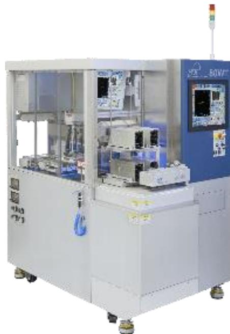
Wetable QFN 是针对汽车电子中对 QFN 封装芯片的焊接可靠性和可检视性的要求发展出的新型的封装结构，可以提供更高的焊接良率和更方便的可视化检测。80WT 适用于 wettable QFN 等对切割深度控制要求高的产品，大型封装基板的阶梯定深切割等场景。80WT 已通过全球头部封测企业日月光等客户端验证，产品性能得到客户的高度认可并形成订单。
