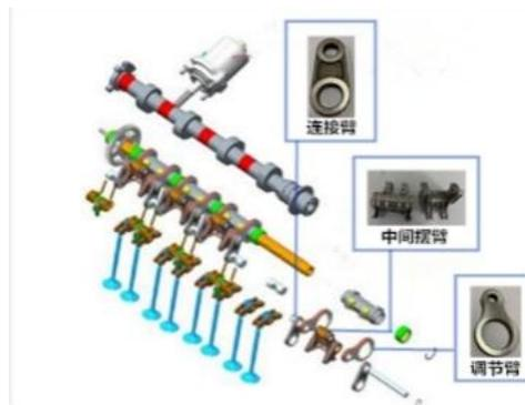
汽车中应用粉末冶金的零部件图示：
