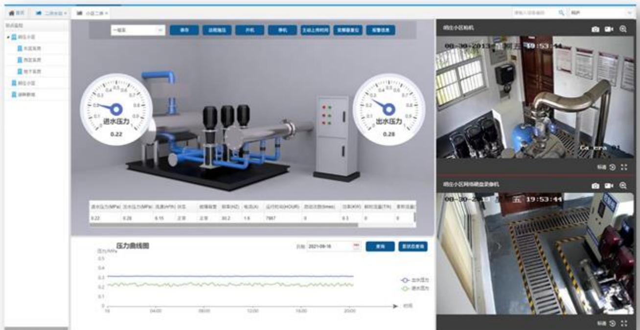
**供水运维系统**主要用于为供水企业的日常运营管理提供支持，主要包括工单系统和巡线管理系统两部分：工单系统可以通过报警信息或自主创建工单并分派任务给员工并进行全程跟踪；巡线管理系统为管道巡查工作提供实时监控，从而更有效的对管道巡查工作进行管理。软件控制界面如下：
