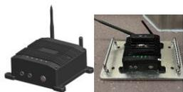
车载振动智能检测仪是轨道动态不平顺病害检测设备，检测分析内容包括：车体振动加速度局部超限分析与晃车原因诊断、车辆运行平稳性分析、车厢内噪声检测分析与极值噪声原因诊断、车厢内噪声与振动数据综合分析。
