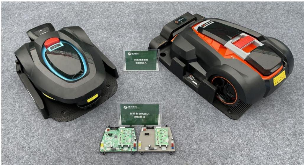
图五：割草机器人电控模块
