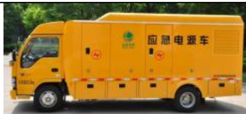
100-200kW 应急电源车
