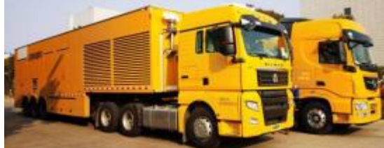
2000kW/10kV 中压电源车
