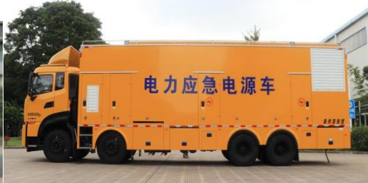
1000kW 中压应急电源车
