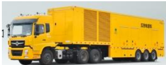
1600kW/10kV 中压电源车
