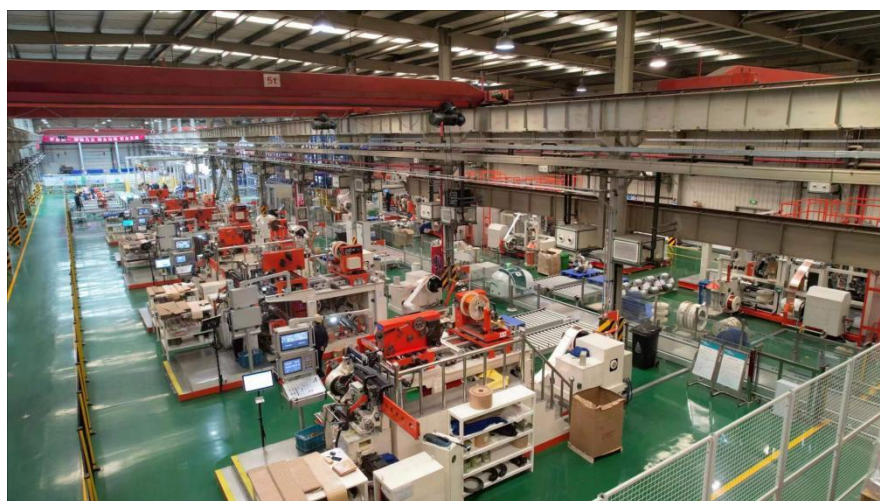
图：非晶合金闭口立体卷铁心配电变压器智能产线
