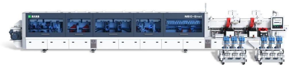
高速自动封边机均采用履带压料，配置电脑控制，采用两组快速上熔胶、两组四通道伺服送带、双精修、双刮边、双抛光、高速仿形等功能配置，可实现不同厚度封边带快速切换。快速上熔胶可缩短胶的加热时间，减少胶的碳化与硫化，提高胶粘性与封边质量，严格根据下熔胶炉需求预熔胶粒，有效保障供胶及时和涂胶量。还可配置 PUR 供胶或热风系统，具有防潮、耐高温、少胶线的特点。
