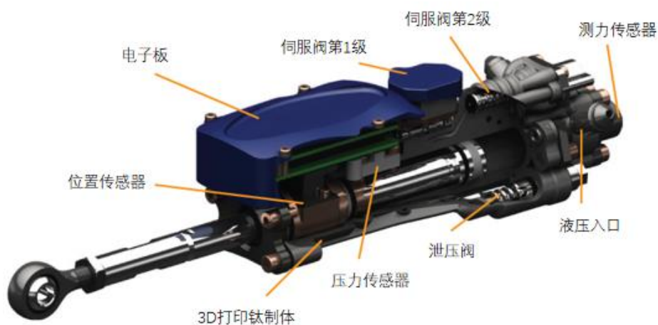
电液驱动关节结构示意图
