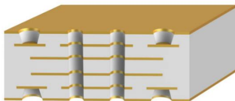
化学沉铜前 (孔壁绝缘基材无铜覆盖)
