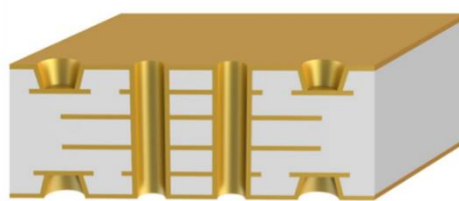
化学沉铜后 (孔壁绝缘基材覆盖铜)
