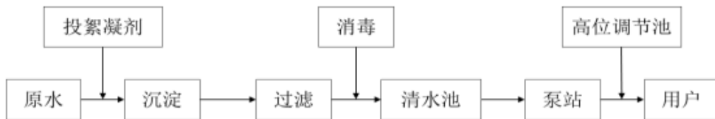
公司自来水生产工艺流程图
