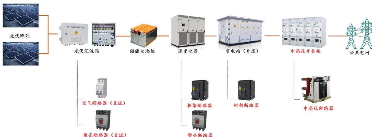
光伏断路器也称作光伏开关，光伏开关的可靠性和稳定性不仅关系到光伏配电系统的安全可靠运行，更关系到光伏行业的稳定发电及收益。此外，由于光伏电站往往工作于昼夜温差大、风沙大、高海拔的恶劣环境下，会加速断路器的老化；分布式光伏电站应用场景则更为复杂，水面、渔光互补电站水汽大、高盐雾的特点又要求产品提升抗盐雾、防腐蚀、防雷的能力。这就需要相关配电设备产品不断提升环境适应能力和抗干扰能力。一般要求光伏开关防护等级达到 IP54 以上，防水、防尘，满足户外长时间使用的要求。
