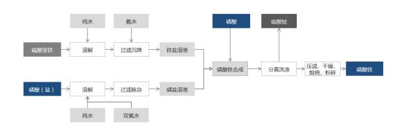
合成的原材料硫酸亚铁溶液与磷酸反应,经沉淀过滤后,加入氨水中和磷酸二氢根离子,合成得到磷酸铁,经过滤、洗涤将硫酸铵分离,再经压滤、干燥、煅烧、粉碎、包装,得到磷酸铁成品。该工艺的特点是采用公司自产的磷酸和磷酸盐,可以进一步降低生产成本,副产品可以作为复合肥生产的原材料,实现资源的综合利用,以及固体废弃物的零排放。
