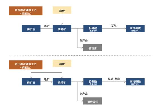
磷矿石的主要成分五氧化二磷( $P_2O_5$ )占比约 30%,氧化钙(CaO)或碳酸钙( $CaCO_3$ )占比 50%,磷矿石制备磷酸的主要流程是将  $P_2O_5$  转变为  $H_3PO_4$ ,并将钙元素分离。传统的湿法磷酸工艺采用硫酸( $H_2SO_4$ )分解磷矿工艺,生产磷酸过程中钙元素形成硫酸钙( $CaSO_4$ )即"磷石膏",环保成本高。芭田股份在传统湿法磷酸工艺的基础上利用硝酸( $HNO_3$ )分解磷矿的工艺生产磷酸,磷矿中的钙元素转化为全水溶的硝酸铵钙( $5Ca(NO_3)_2NH_4NO_3$ ),没有"磷石膏"产生,硝酸铵钙直接作为水溶性肥料出售,能够做到资源利用最大化,根本上解决磷石膏污染问题。
