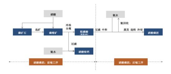
由上图可知,硝酸法生产高纯磷酸项目的前端工序,即硝酸分解磷矿工艺,与公司现有粗磷酸和硝酸磷肥的前端制备工艺基本一致。区别为:高纯磷酸的制备需要增加脱钙流程去除水溶性钙离子(增加少量硫酸与钙离子反应,沉淀、过滤,生成工业级硫酸钙),而粗磷酸和硝酸磷肥无需脱钙。2020年度、2021年度、2022年度和2023年1-6月,发行人采用硝酸分解磷矿工艺技术生产粗磷酸的产量分别为5.59万吨、6.74万吨、8.57万吨和4.64万吨,已经实现量产且工艺技术成熟稳定,产量稳步增长。
