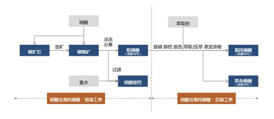
磷矿石制备高纯磷酸的工艺整体可分为两个工序,前端工序:磷矿石→粗磷酸(浓度 46%),后端工序:粗磷酸(浓度 46%)→高纯磷酸(浓度 85%)。前端工序制备的粗磷酸由于含杂质较多,一般用于制造磷肥;后端工序经过萃取、除杂、浓缩制备高纯磷酸,业内工艺相对通用。根据《HG/T4069-2022 工业湿法净化磷酸标准》,对85%的湿法净化磷酸中铁、铝、钙、氟等元素也有较高要求。
