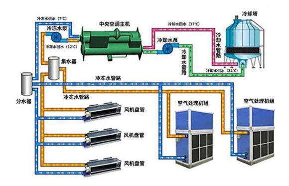
上图中,中央空调主机、风机盘管、空气处理机组为发行人的产品类别,冷却塔为国祥冷却的产品类别。
