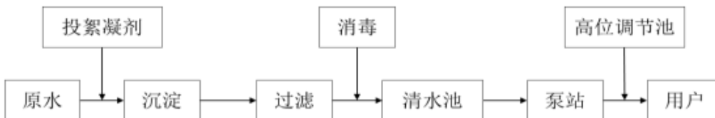
公司自来水生产工艺流程图
