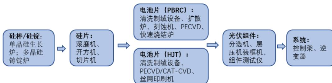
公司生产的单晶硅生长真空炉体为晶体生长设备的重要部件，应用于硅片制造环节，硅片生产工艺流程图如下：
