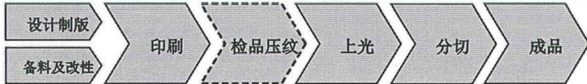
图 1 扑克牌生产流程
