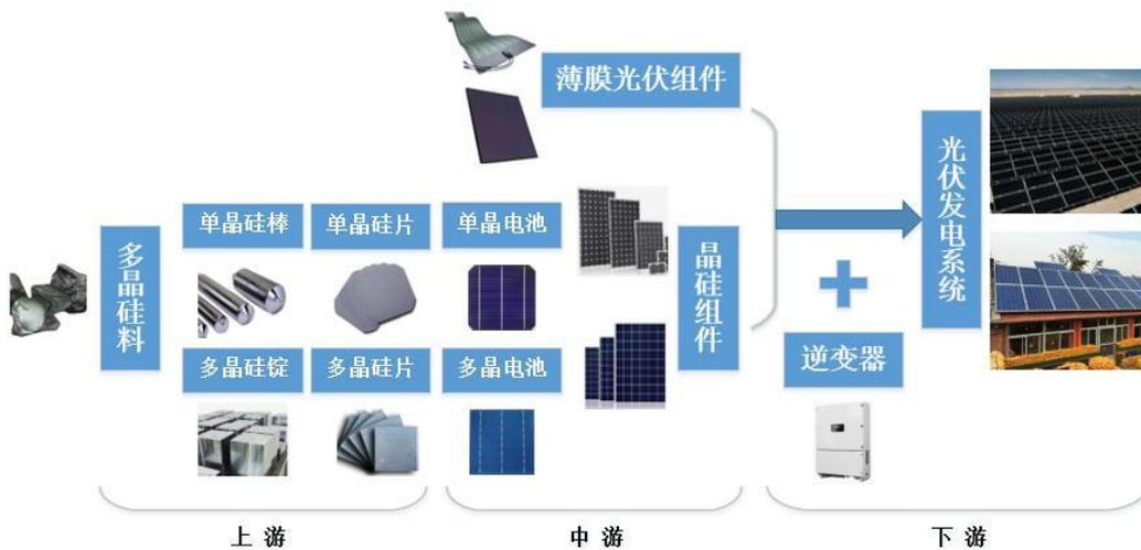
光伏产业链构成如上图所示。光伏行业产业链包括硅料、硅片、电池片、组件等，中国光伏发电产业链上游参与者为硅片、银浆、PET基膜及氟膜等领域供应商；中游主体为电池片、光伏玻璃、逆变器等制造商；下游涉及光伏电站及不同的应用场景。由于光伏电池片是光伏发电的“心脏”，因此以光伏发电为主的产业链中游为中国光伏发电的核心。
