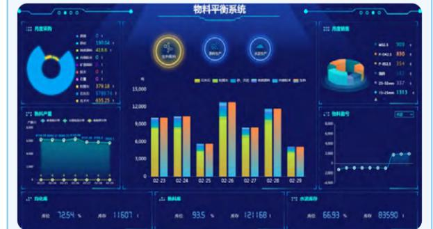
為及時、準確地反應物料消耗、產量以及庫存情況，海螺水泥自主開發物料平衡系統，歷時一年時間，於2023年2月正式上線運行，系統以進、出廠貿易結算數據及生產計量實時數據為基礎，結合三維掃描等過程盤點數據，採用動態平衡分析算法，校驗物料賬面庫存、實際庫存數據，平衡水泥生產過程中物料關係，實現庫存自動盤點，每日的產消量自動計算，消除生產過程中計量設備的累計誤差和人工盤庫的統計誤差。系統的成功應用提高了數據的準確性、及時性和可信度，為碳排放數據統計、核對等工作提供了技術支撐，有利於促進水泥行業低碳發展。
