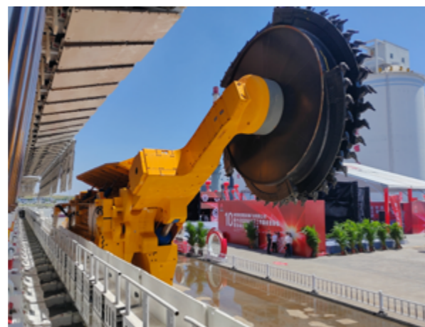
世界首套 10米超大采高智能综采工作面成套装备
