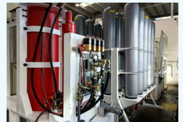
国内首台 流量超过 3000l/min 的安全阀测试平台
