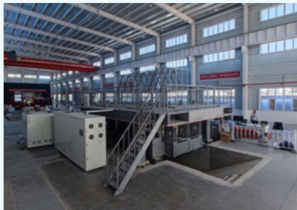
国内首套 1:1 比例锚杆护表构件实验系统
