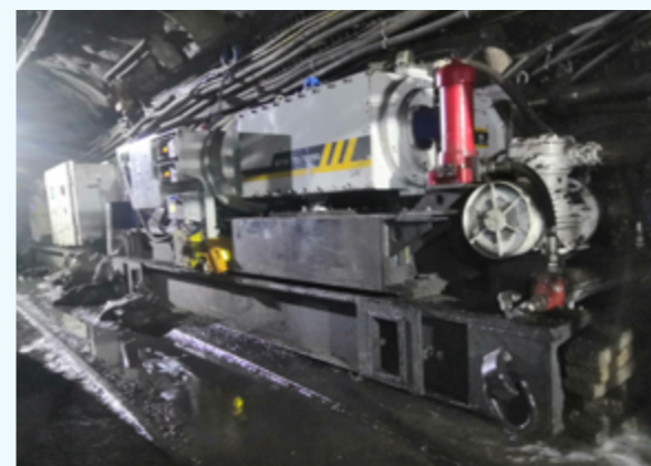
国内首台 制动功率 1000kW 压裂泵
