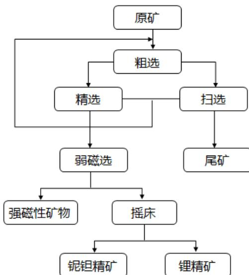
2、锂盐、金属锂的生产工艺流程
