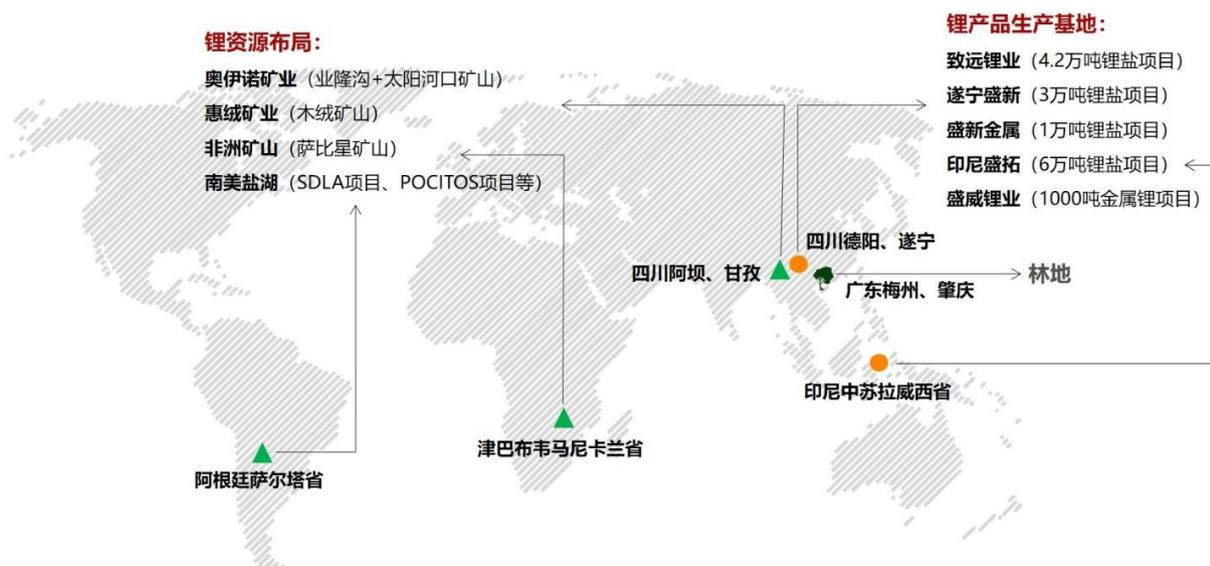
公司在全球范围内建有锂产品生产基地：（1）致远锂业位于四川省德阳市绵竹德阿生态经济产业园，已建成产能为年产4.2万吨锂盐（其中碳酸锂2.5万吨、氢氧化锂1.5万吨、氯化锂2,000吨）；（2）遂宁盛新位于四川省遂宁市射洪经济开发区锂电产业园，已建成产能为年产3万吨锂盐（全部为氢氧化锂，其中
