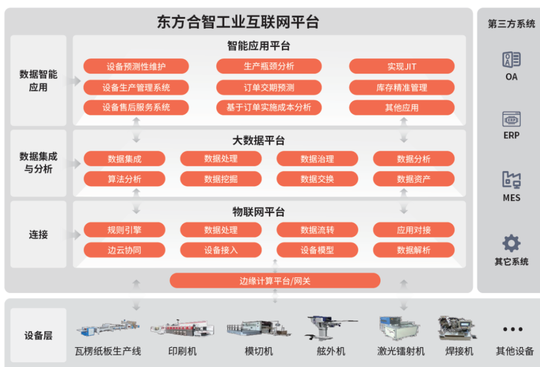
图：iDataPioneer工业互联网平台架构示意图
