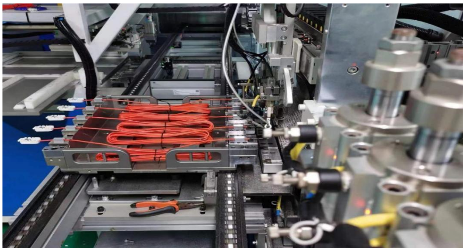
图九 工业电子雷管自动化生产线
