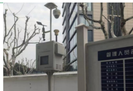
施工现场设置扬尘监控设备
