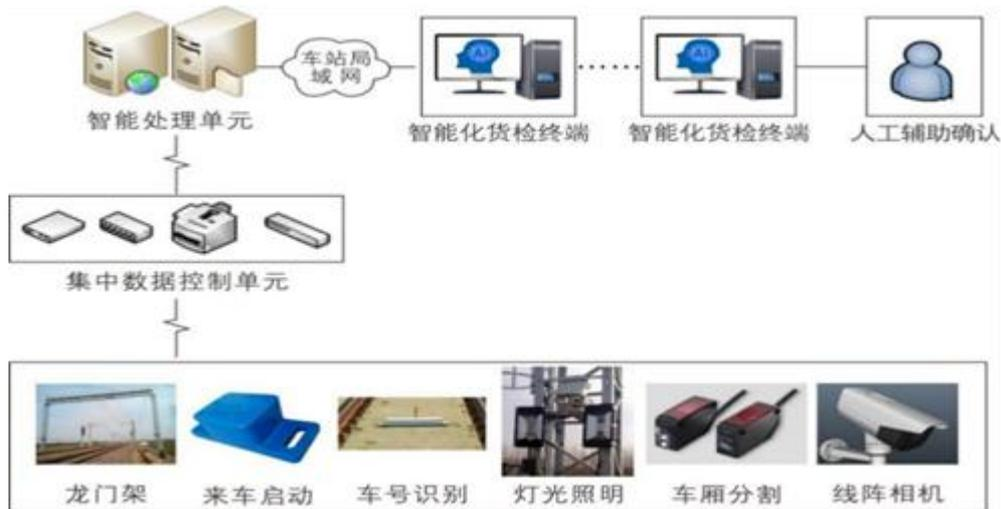
图 12：货车装载状态高清智能检测系统
