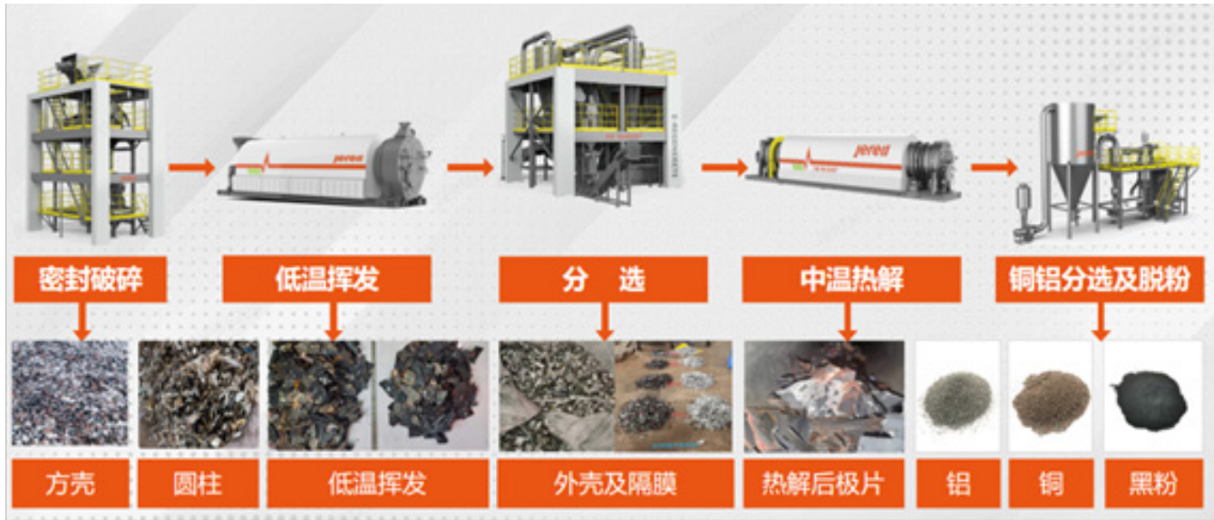
锂电池资源化回收利用工艺流程图
