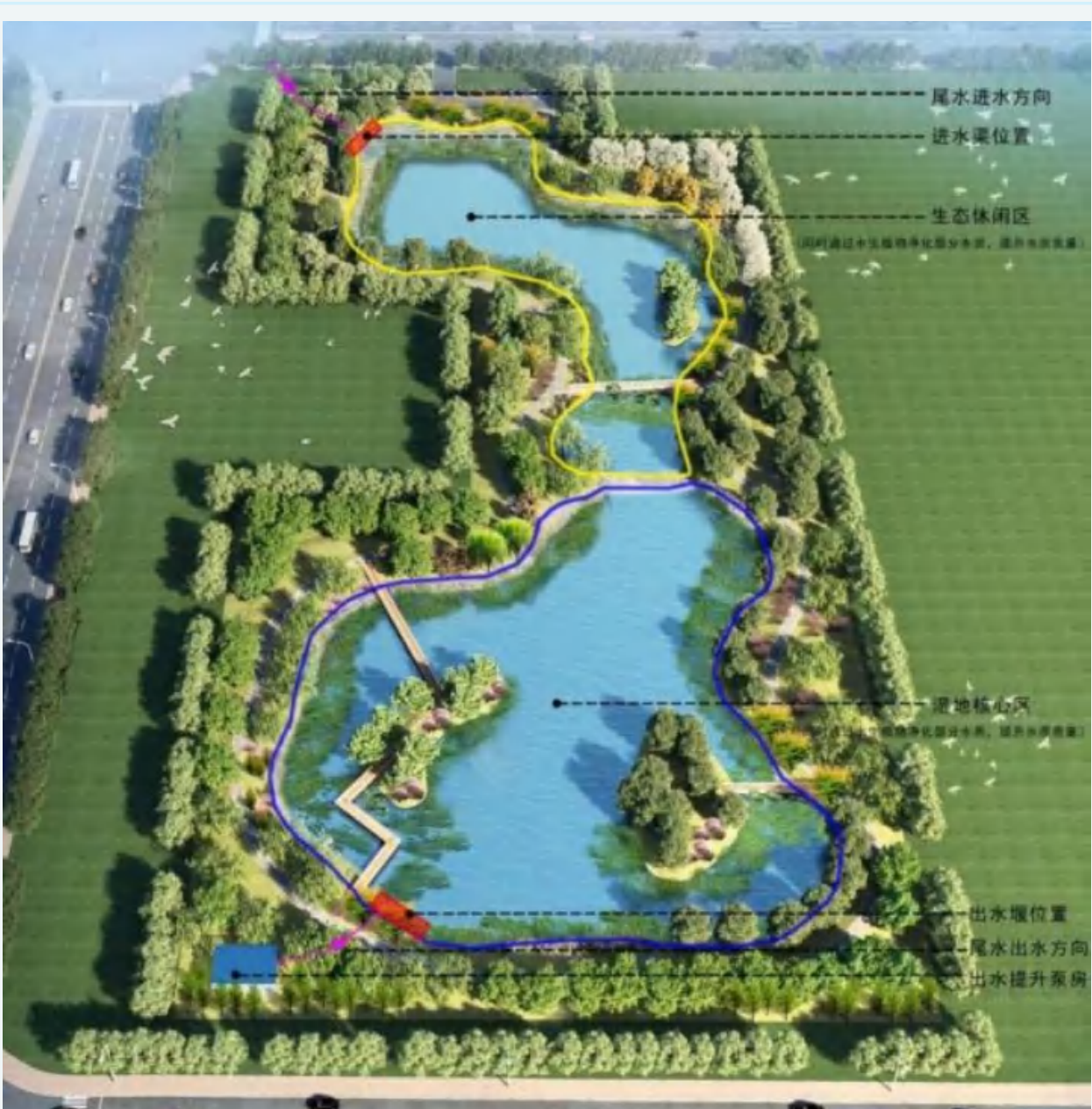
碧水源选用人工湿地处理污水厂尾水保证出水水质的稳定性
