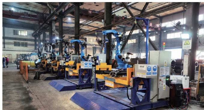
塔脚焊接机器人
