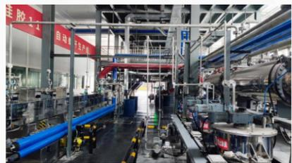
关羽路基地双螺杆全自动生产线正式建成投产，增加光伏单组分有机硅密封胶产能约3万吨/年
