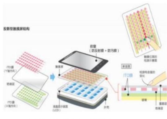
ITO 导电膜基本结构如下图所示：
