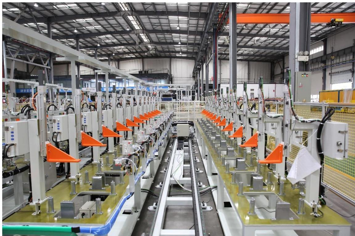
图：应用于车载冰箱焊接、装配、检测智能化生产线
