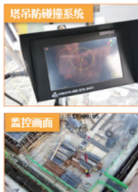
塔吊防碰撞系统
